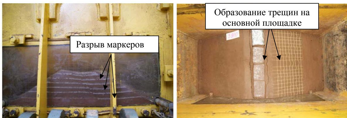
Рисунок 7 – Фото модели насыпи после моделирования. Статическая нагрузка 115 кПа
